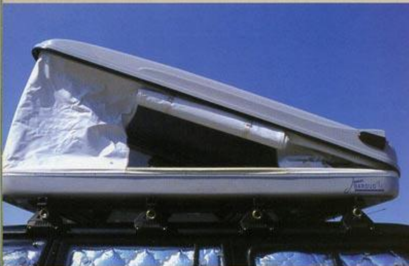
La tente est solidement arrimée aux barres Rhino Rack par des pattes en acier inox à visserie freinée de 8 mm.
